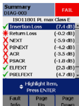
图4:自动测试完成后,测试仪的屏幕将显示所选测试标准的测试参数列表。用红色X标出的参数表示测试未通过。测试仪还将在屏幕右侧括号中显示每个参数的最差“差值”。
